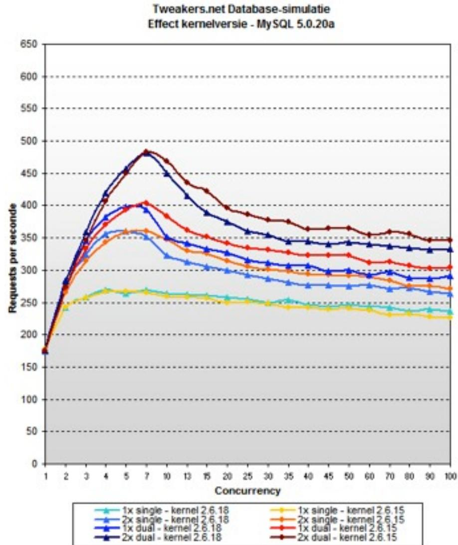
Fonte: Database test: dual Intel Xeon 5160
