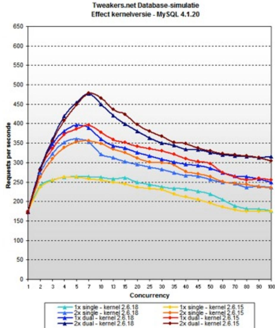
Fonte: Database test: dual Intel Xeon 5160
